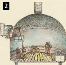
Pou de gel. Estructura de planta circular coberta amb una cúpula, on s'emmagatzemava el glaç del riu o de neu compactat durant els mesos més freds i es comercialitzava entre abril i octubre. S'utilitzà des del s. XVII al XIX.
