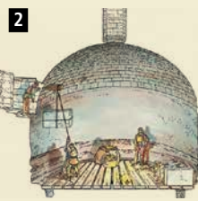
Poza de hielo. Estructura de planta circular cubierta con una cúpula, donde se almacenaba el hielo del río o de nieve compactada durante los meses más fríos y se comercializaba entre abril y octubre. Se utilizó desde el siglo XVII hasta el XIX.
